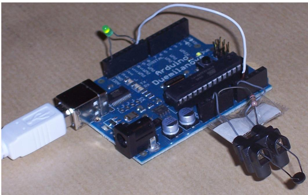
L'expérience va consister à mesurer la température à la borne 0, ainsi que la tension moyenne de la sortie PWM, pendant que la tension à cette sortie va varier en fonction du temps.
